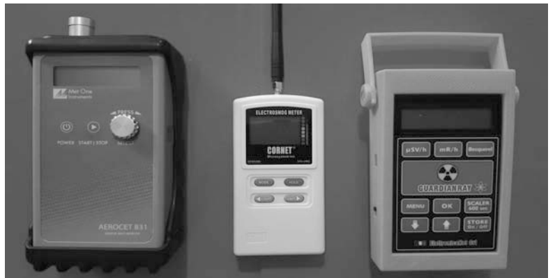
Strumenti acquistati dal comitato, da sinistra a destra: Misuratore di polveri sottili, Misuratore di elettrosmog da onde elettromagnetiche, Misuratore di Radioattività.
